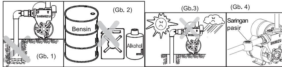
11. Bila pompa selesai dipasang pada sumur yang mudah menghisap kotoran terutama pasir maka diperlukan adanya saringan pasir. Hal ini untuk mencegah impeller pada pompa cepat aus (rusak) dalam waktu singkat, penurunan tekanan dan mengurangi kapasitas air yang dipompa (Gb. 4)
